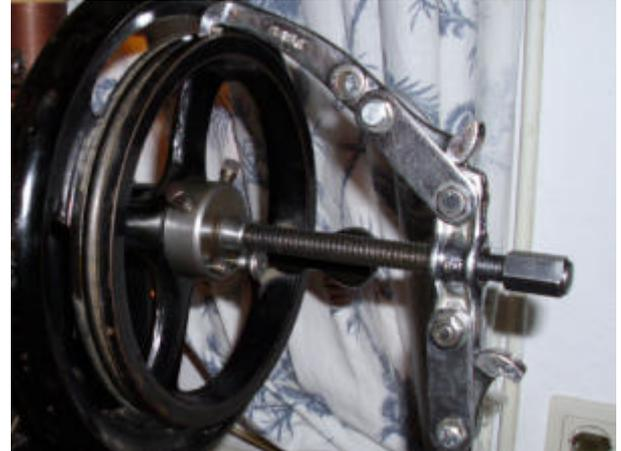
Mitnehmer-Muffe: 4-Kant-Klemmschrauben öffnen (SW 8) Schrauben lösen, aber nicht ganz herausdrehen. Abzieher aufsetzen, am Kranz des Lederriemens oben einhaken, ....
