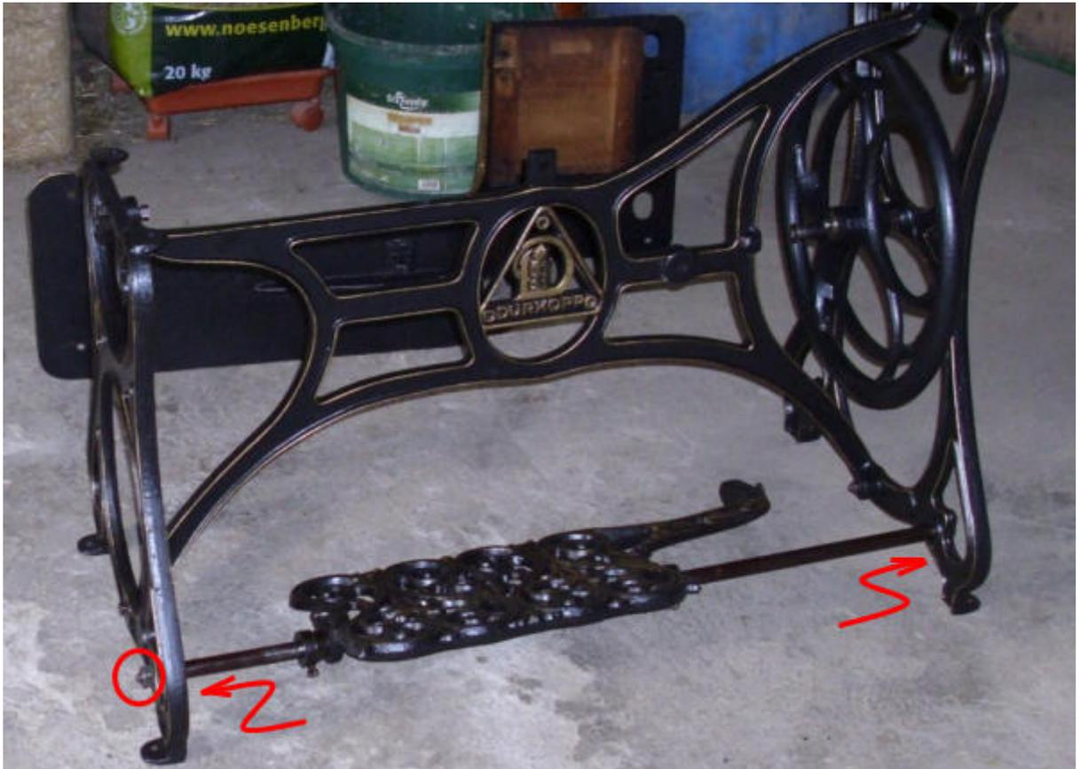
Bei Triebstange aus Holz Lagerstellen mit Vaseline schmieren, zwischen Schwungrad und Arm der Trittplatte einsetzen. Lagerkegel der Trittplatte mit Vaseline fetten, auf „leichtes Spiel“ einstellen, Klemmschrauben anziehen. Endmutter der Trittachse und alle Schraubverbindungen im Untergestell nun auf „handfest“ anziehen .
