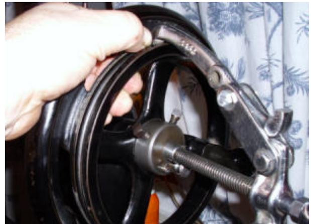
.... einstellen, unten einhaken. Schraubenschlüssel SW 15 auf das Sechseck am Ende der Spindel des Abziehers ansetzen, Rad mit Abzieher am Kranz nach rechts abziehen, dabei mit linker Hand gut festhalten (Der Abzieher darf runter fallen, das Rad nicht!)
