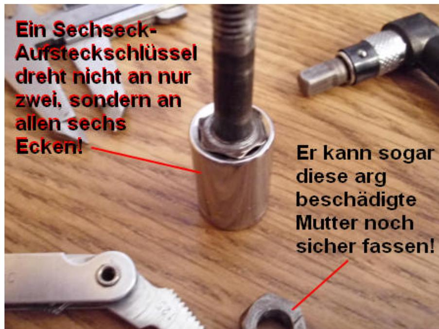
So sieht ein Schlüssel aus, der sicher faßt: An allen sechs Ecken des Schraubenkopfes zugleich!
