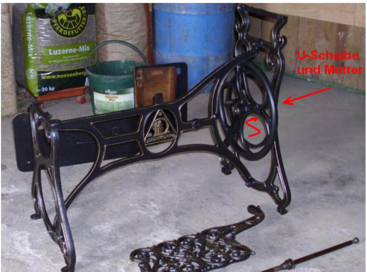
Trittachse in Trittplatte einschieben, Lagerkonus aufschieben, Achse in Untergestell einsetzen
