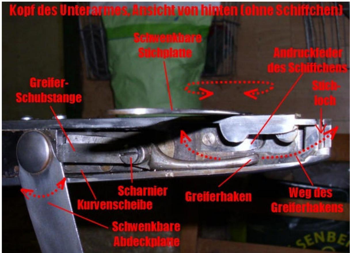
Der Kopf des Freiarmes geöffnet und von hinten betrachtet. Hier kann man - anders als bei anderen Herstellern/Typen -- dem Spiel von Nadel, Schiffchen und Greiferhaken (Schlingenfänger) zusehen - auch im langsamsten Betrieb von Hand. Es ist lehrreich, dies zu tun, insbesondere wenn man nach der Lösung eines Nähproblems sucht.
