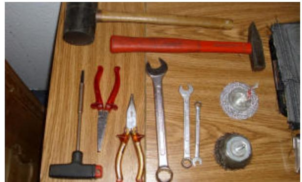
Winkelgriff mit 6-eck-Aufsteckschlüssel und scharfen Bits Maulringschlüssel, T-Griff, Zangen, Bürsten, Gummihammer.
