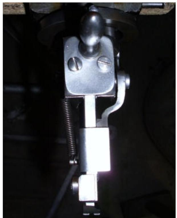
(Der eigentliche Transporteur samt Fuß „hängt“ nur im Gehäuseschlitz und wird von der Rückholfeder in Position gehalten. Der Andruckring preßt ihn nach unten aufs Nahtgut, Transportstößelring und Kipphebel bewegen ihn nach hinten. Das Abheben und den Vorlauf übernimmt in beiden Fällen die Rückholfeder, die nach oben und nach vorn zieht.)
