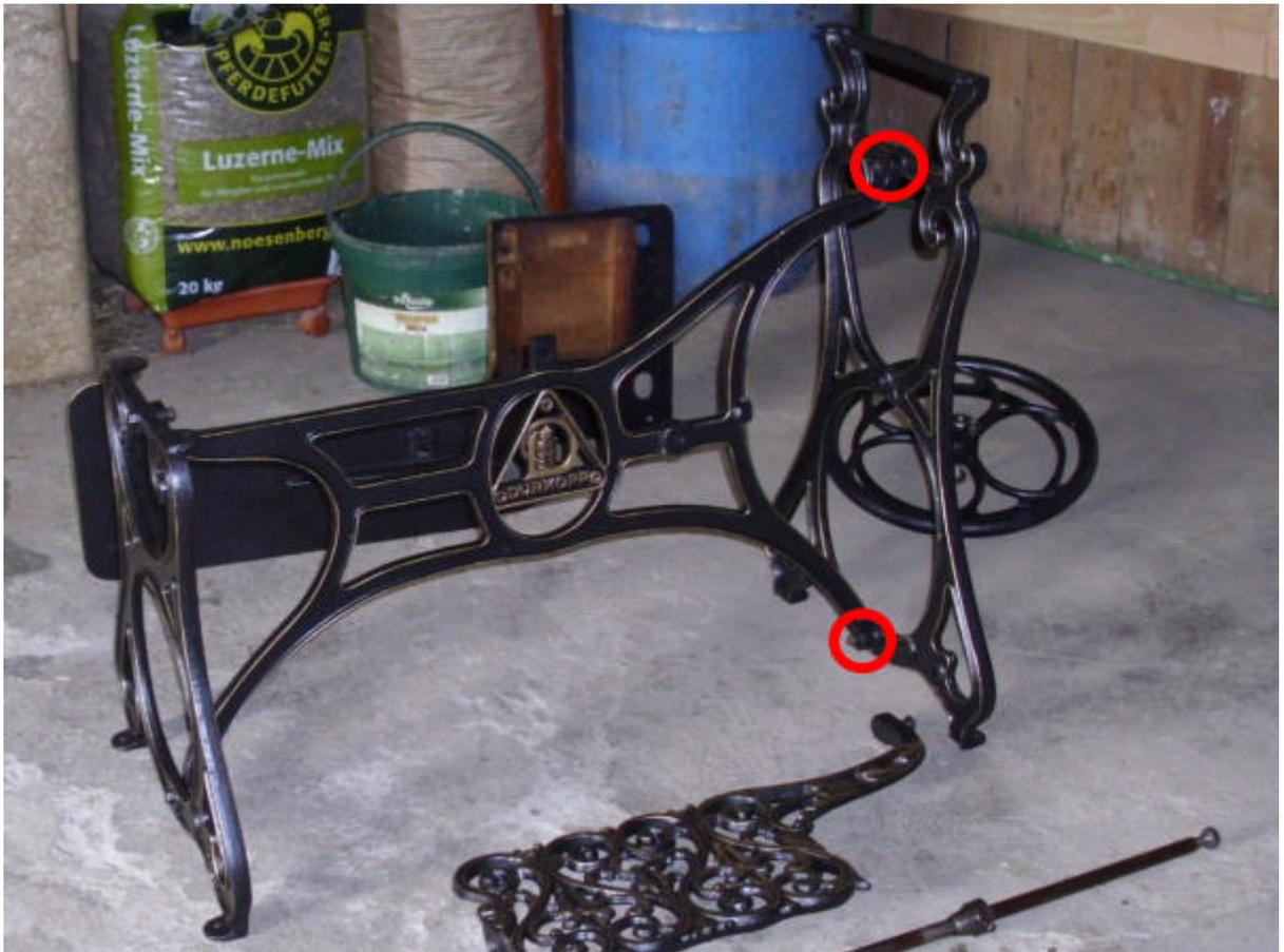
Schwungrad mit voreingestelltem Lagerspiel einbauen, Lagerspiel endgültig einstellen, festziehen und Kontern -- kann sein, daß rechtes Seitenteil oben noch mal aufgeschraubt werden muß, dann montiert sich's leichter.
