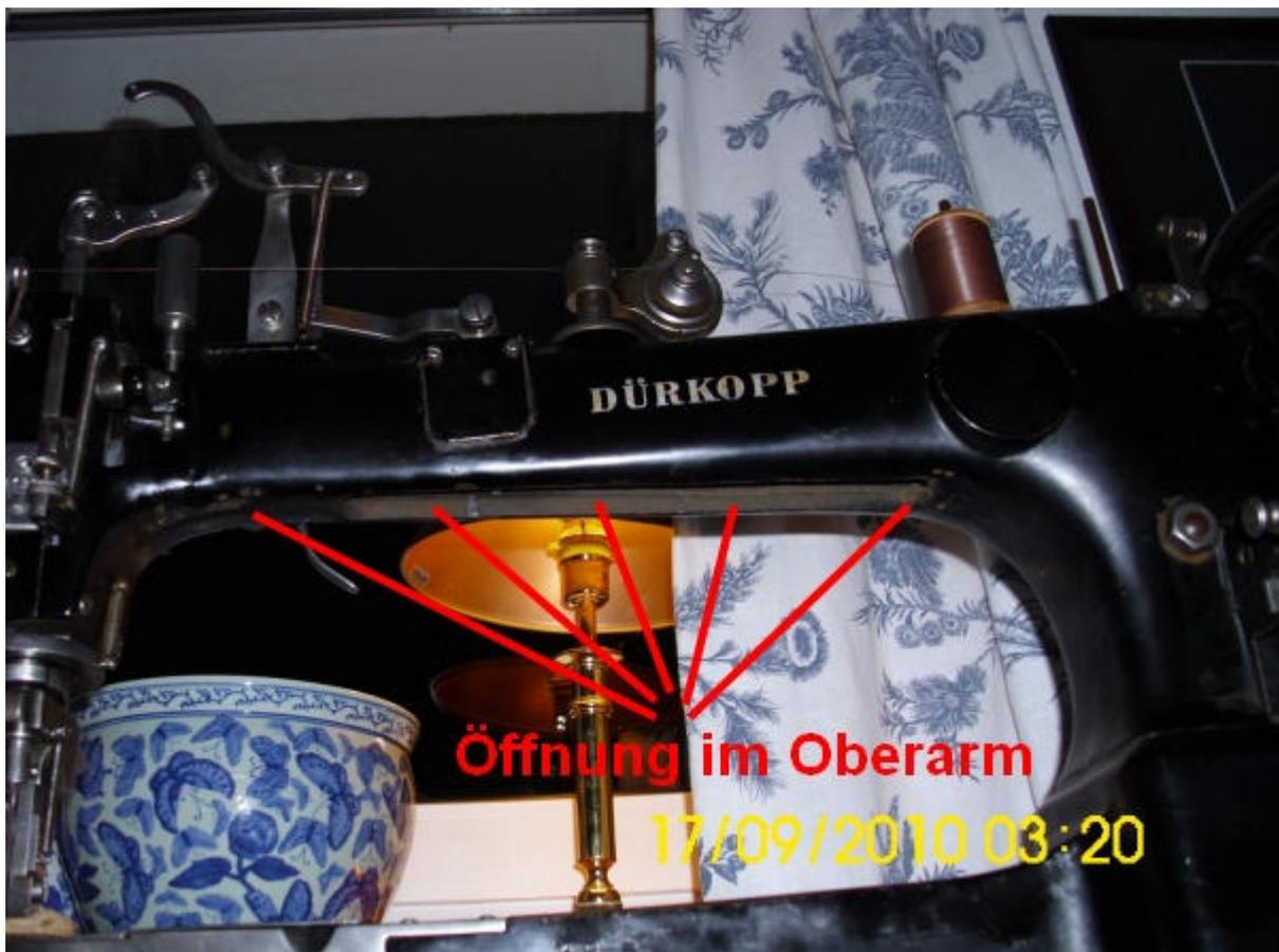
c) **Sinngemäß Teil um Teil, Baugruppe um Baugruppe, Schraube um Schraube einzeln lösen / abbauen, reinigen, mit Korrosions-Schutzöl einreiben, und dann - wo immer möglich und sinnvoll - sofort wieder zusammen- und anbauen.** (Das erspart mir später das Ratespiel: "Wozu war das nochmal gut?", oder "Wohin gehört nochmal diese Sch...-Schraube?")
