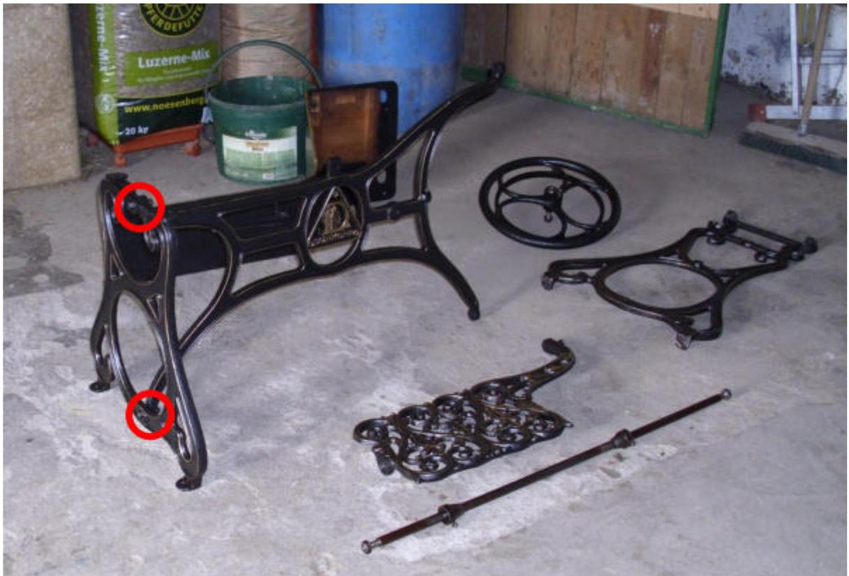
Rechtes Seitenteil lose mit Mittelteil verschrauben
