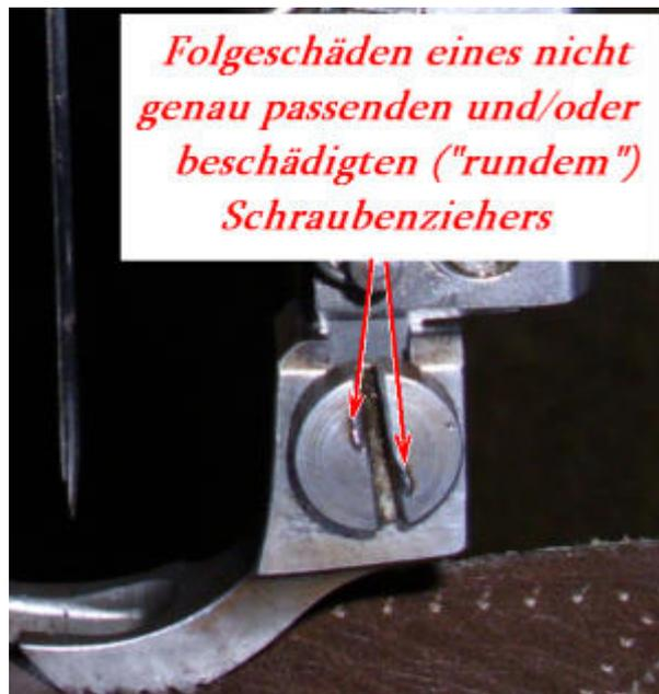
**Das** macht ein ausgeleierterter und zu kleiner Schraubenzieher mit runden Kanten aus einer Schlitzschraube bei dem vergeblichen Versuch, sie zu **lösen**. Das endet oft in einem schnell und heftig ablaufenden „coming out“, und je runder die Kanten des Schlitzes im Schraubenkopf werden, desto schwieriger wird dann das Drehen dieser Schraube!
