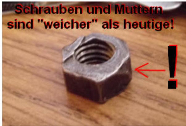
Es ist, wie gesagt, keine Schande, nachzumessen, bevor man schraubt, und sich einen genau passenden Steckschlüsselsatz oder einen Ring-Schraubenschlüsselsatz für SW 8 bis 22 zu leisten und zu verwenden. Das wird sicher bei der Montage eine Menge Ärger ersparen!
