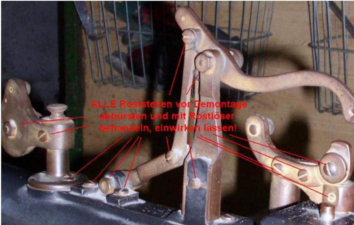
Verrostete Schraubverbindungen: Rost an dem oberen Arm der DÜRKOPP #24139
